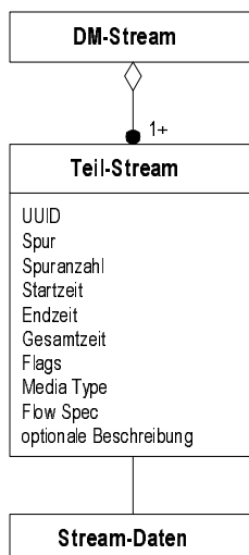
Abbildung 5.4 Objektmodell eines DM-Streams
